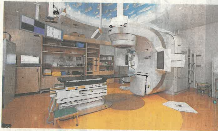
最新の高精度放射線治療装置。定位放射線治療や強度変調放射線治療などを短時間に行うことができる＝徳大病院
