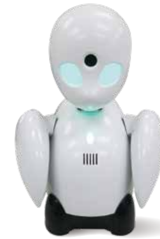
分身ロボット「オリヒメ」はカメラ、スピーカー、マイクを搭載した遠隔操作が可能な分身ロボットです。
